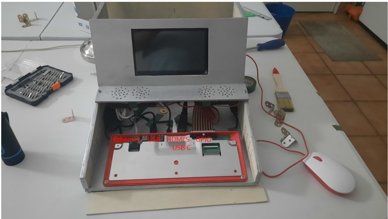
Aseguramiento de la Raspberry PI 400 y de sus cables
