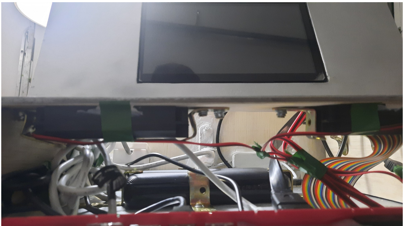
Aseguramiento de la Raspberry PI 400 y de sus cables
